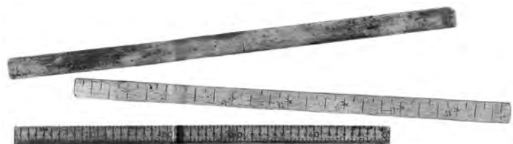
Abb. 46: Masstäbe aus Holz 19. Jh mit Einkerbungen, Zoll- und Zentimereinteilungen (Schadwinkel 1986, S. 45)
