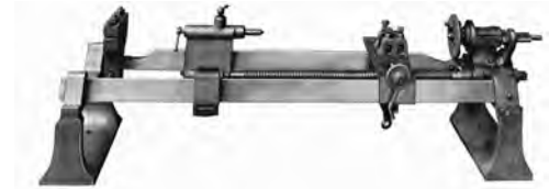
Abb. 57: Maschinen-Werkzeug-Technik: Henry Maudslays srew-cutting lathe, 1797 (Lilley 1966, Tafel XIX)
