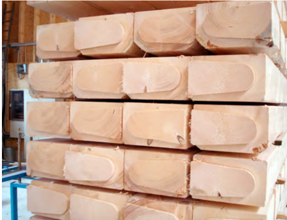
Abb. 120: Schwalbenschwanz-Holzverbindung als Positionierungshilfe in Wandaufbauten und Dachstühlen (Hector Egger Holzbau AG, Langenthal, 2006; Fotos: Autor)
