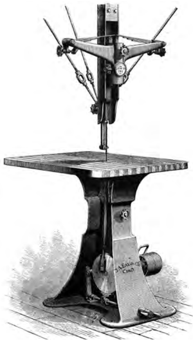
Abb. 68: Dampfbetriebene Decoupiersäge (Powis Bale 1880, S. 140)
