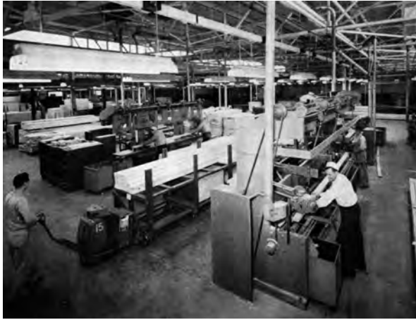
Abb. 96: Fertigung bei Gunnison, New Albany (Indiana, USA): Zuschnitt der Ständer (Kelly 1951, Abb. 39/2)
