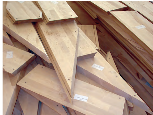
Abb. 110: Bezeichnung der Bauteile mittels manuell aufgetragener, handelsüblicher Adressaufkleber, die mit einem Laserdrucker bedruckt wurden (Foto: Fabian Scheurer)
