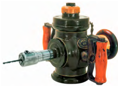
Abb. 18: Formfindung: Handbohrmaschine 1895, Firma Fein, Stuttgart (erstes Elektrowerkzeug der Welt)
