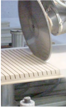
Abb. 128: Fertigungsschritte Zipshape: 1) Einfräsen der 1. Zinkenflanke mit dem Sägeblatt auf der 5-Achs-Fräse, 2) Einfräsen der 2. Zinkenflanke, 3) Manuelles Fügen der Platten und Verleimung im Vakuumsack (Fotos 1–2: Bach Heiden AG, Hansueli Dumelin; Foto 3: Robert Aimer)
