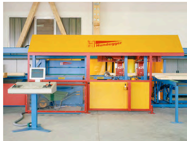
Abb. 106: Vollautomatische Abbundmaschine 2009: Firma Hundegger, K2i ( www.hundegger.de , Zugang 07.02.2009)
