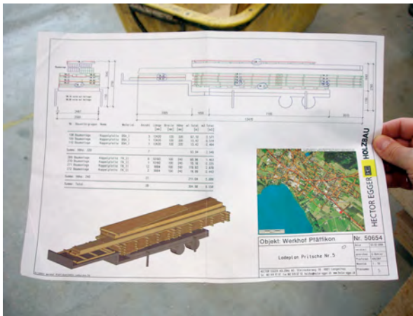
Abb. 114: Multifunktionalität des Datensatzes: Der Datensatz, aus dem das NC-Programm zur Ansteuerung der Abbundmaschine erzeugt wird, dient ebenso zum Ausdruck von Ladeplänen mit Anfahrtsbeschreibung. (Hector Egger, 2006; Foto: Autor)
