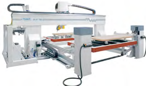
Abb. 105: 5-Achs Bearbeitungszentrum 2009, Firma Maka, CR 27 TBZ ( www.maka.com , Zugang 07.02.2009)
