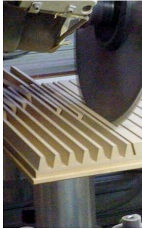
Abb. 128: Fertigungsschritte Zipshape: 1) Einfräsen der 1. Zinkenflanke mit dem Sägeblatt auf der 5-Achs-Fräse, 2) Einfräsen der 2. Zinkenflanke, 3) Manuelles Fügen der Platten und Verleimung im Vakuumsack (Fotos 1–2: Bach Heiden AG, Hansueli Dumelin; Foto 3: Robert Aimer)
