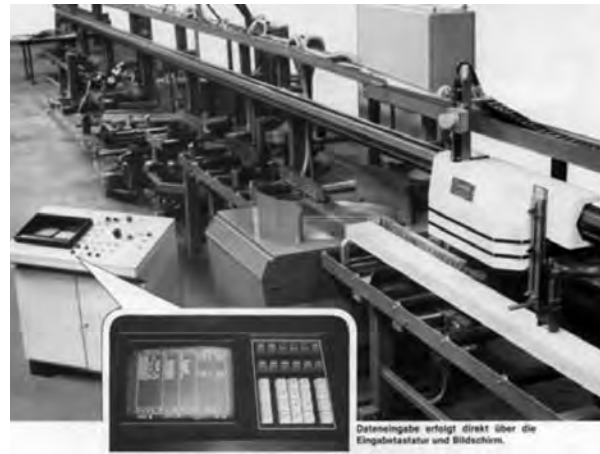
Abb. 104: Erste CNC-Abbundmaschine 1984: Firma Burmek, SPL 270-1 (Grau 2002, S. 4)
