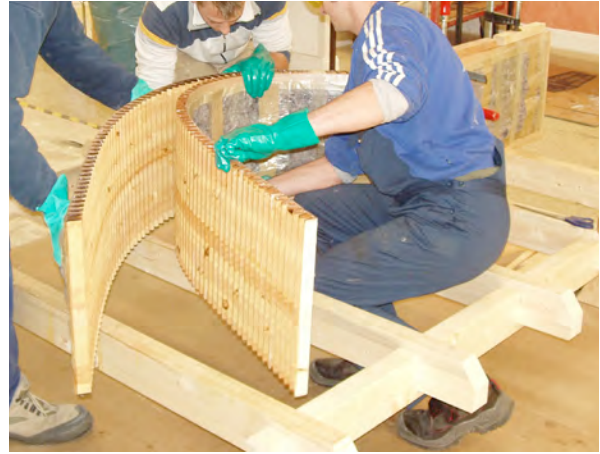
Abb. 128: Fertigungsschritte Zipshape: 1) Einfräsen der 1. Zinkenflanke mit dem Sägeblatt auf der 5-Achs-Fräse, 2) Einfräsen der 2. Zinkenflanke, 3) Manuelles Fügen der Platten und Verleimung im Vakuumsack (Fotos 1–2: Bach Heiden AG, Hansueli Dumelin; Foto 3: Robert Aimer)
