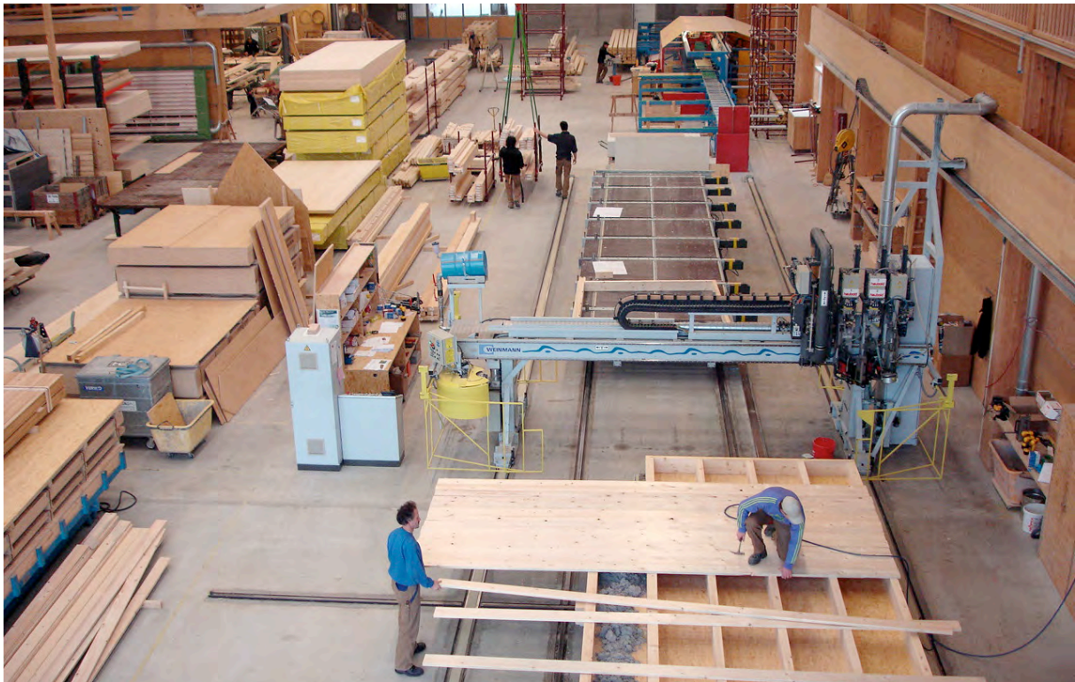
Abb. 113: Flexible Fertigungsstrasse bei Hector Egger Holzbau AG, Langenthal Schweiz, 2006. Im Hintergrund ist eine Hundegger Abbundmaschine zu sehen, im Anschluss eine Weinmann Multifunktionsbrücke mit Leim- und Nagelfunktion und im Vordergrund eine Plattform zum Wenden der Elemente (Foto: Autor)
